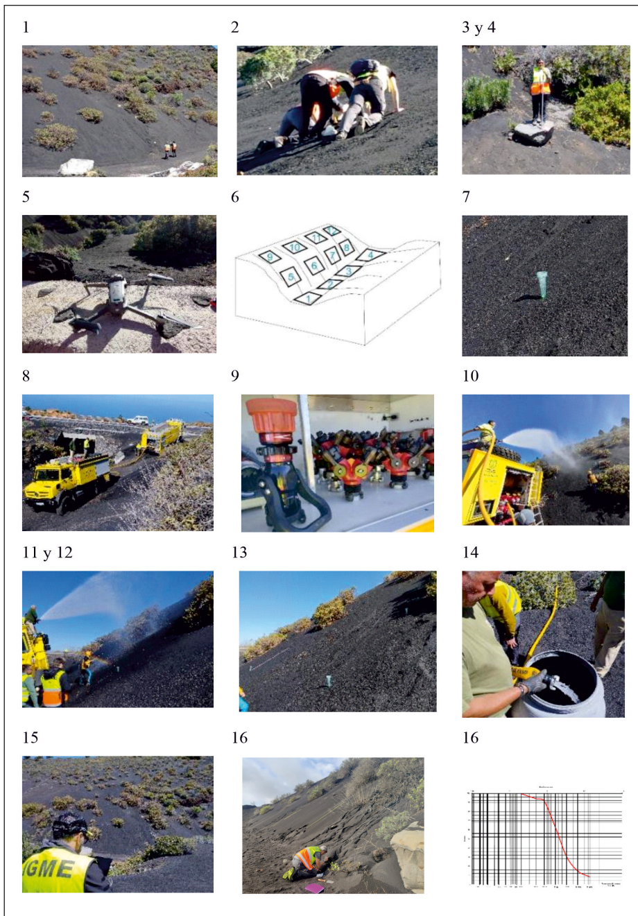
Figura 5. Tareas para la realización de los ensayos de removilización de piroclastos en las laderas, lecho y replanos del barranco de Tamanca (véase explicación según la numeración en el texto)
