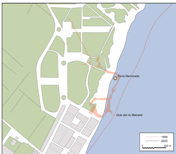
Figura 7. Un exemple llampant de l'erosió litoral: la Torre Derrocada. Al sud del Grau de Moncofa i provocat per l'equivocat bastiment d'espigons protectors (1973-1975) ocasionà la ruïna de la torre de Beniesma (segle XVI) que estava a més de 100 m de la costa. Aquest és el resultat de la inconsiderada construcció d'obres “regeneradores”.
