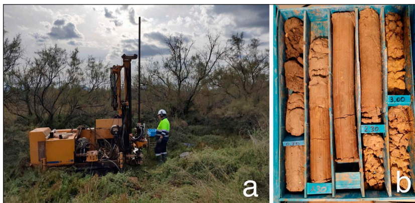
Figura 2. Detall de l'extracció del sondeig de Can Cuirassa (ABF-02) mitjançant una màquina Rolatec a percussió (a) i recuperació del testimoni continu (b)
