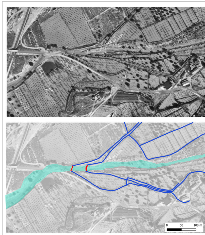
Figura 7. Detall d'un fotograma del Vol de 1982 i interpretació d'assut i presa (en vermell) junt amb boqueres (blau fosc) a la rambla de Pepió (blau clar) (Cases d'Espanya, el Verdegàs, Camp d'Alacant)
