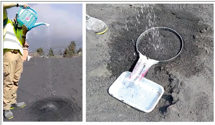
Figura 3. Materiales básicos necesarios para los ensayos de lluvia artificial en microparcels experimentales en interfluvios y medición de la escorrentía y la removilización de piroclastos empleados durante la emergencia volcánica de 2021 en la isla de La Palma
