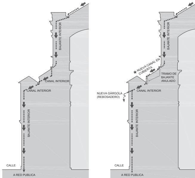
Plano de evacuación de aguas pluviales. Cubiertas bajas correspondientes a C. Campanas y lateral norte de la cubierta principal. Catedral de Jaén
