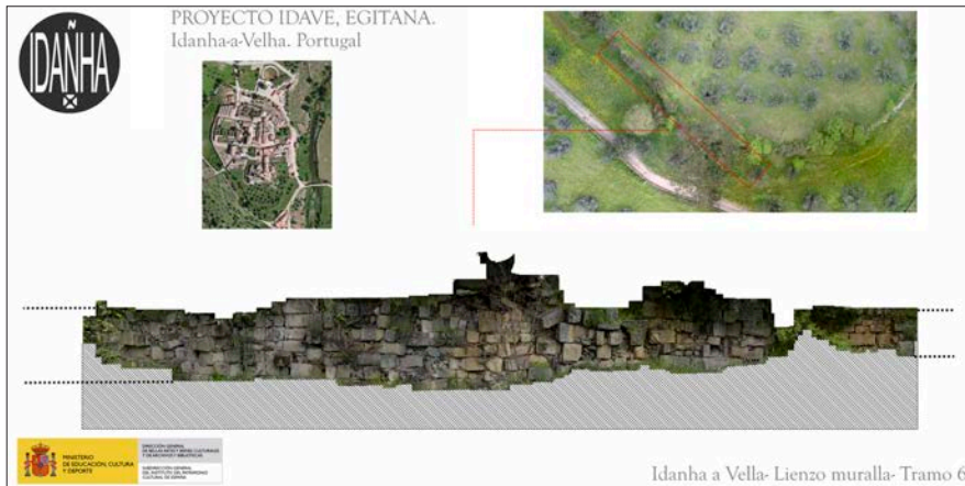
Fig. 10: Fotogrametría vertical con uso de dron del tramo 6 de la muralla de Idanha-a-Velha (Proyecto IdaVe).
