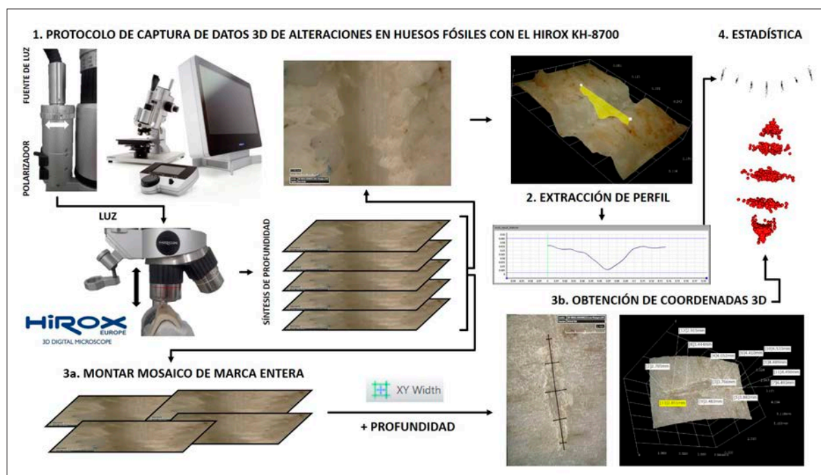
Fig. 6: Protocolo para la Obtención de Datos de MG utilizando el Microscopio Digital 3D HIROX KH-8700 (Courtenay 2019).
